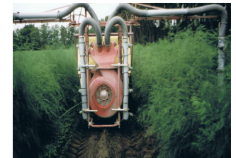
Traitement air dirigé
